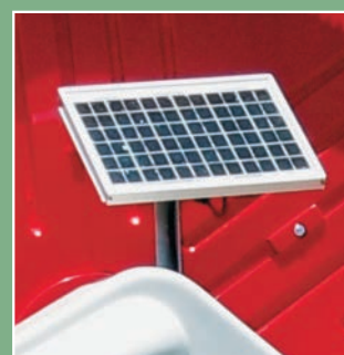
Placa Solar para recarga de bateria
