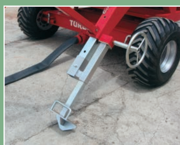
Redutor mecânico para levantar das âncoras e sistema de entrada de água pelo chassi
