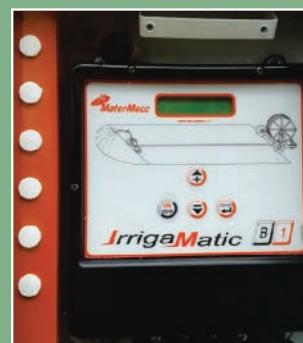
Painel eletrônico de controle de velocidade
