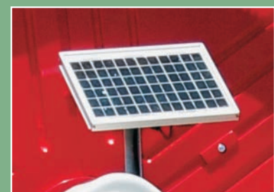
Placa Solar para recarga de bateria
