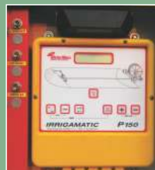
Painel eletrônico de controle de velocidade
