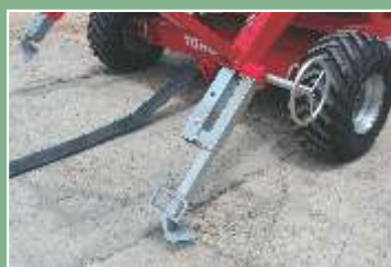
Redutor mecânico para levante das âncoras e sistema de entrada de água pelo chassi
