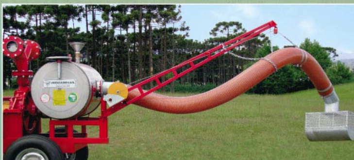
Tanque de escorva, mangote e guincho
