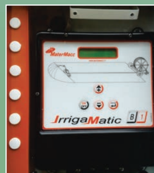
Painel eletrônico de controle de velocidade
